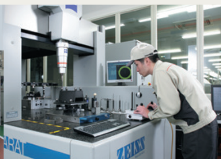
QA实验室 三坐标测量及元素、表面分析
