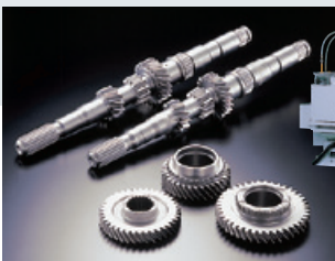
变速齿轮的真空浸碳处理
