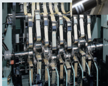
强力抛光机 曲轴、凸轮轴的研磨加工
