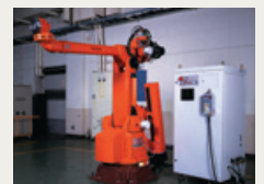
世界第一个电动型多关节焊接机器人 / 1979年
