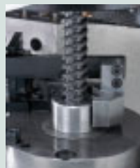
■ 照片2 photo2 MQL拉削加工 MQL Broaching 通过使环保型的植物油雾化，实现了利用微量供油进行加工
