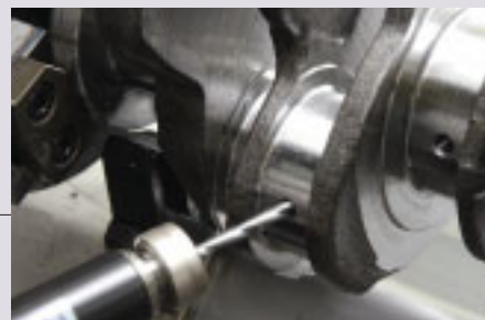
对曲轴进行的钻孔加工 MQL machining of a crankshaft
