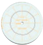
圆度 2.8 μm Roundness 2.8 μm
