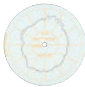
圆度 17.2 μm Roundness 17.2 μm
