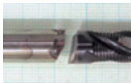
钻柄部位的折损（夹套内）
