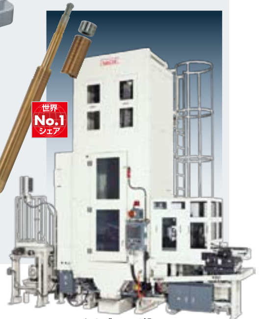
NCヘリカルブローチ盤 オートマチックトランスミッション用 ヘリカルギヤの高効率加工を実現
