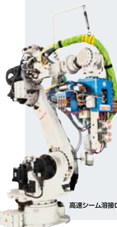
スポット溶接用ロボット 大型ハンドリング用ロボット 高い生産性を実現
