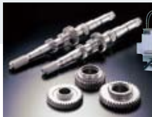
ミッションギヤの真空浸炭処理
