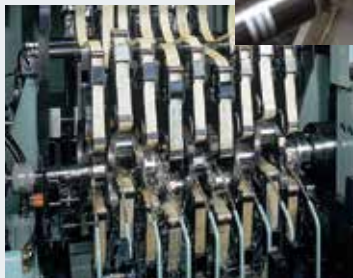
パワーフィニッシャ クランクシャフト、カムシャフトをラッピング加工
