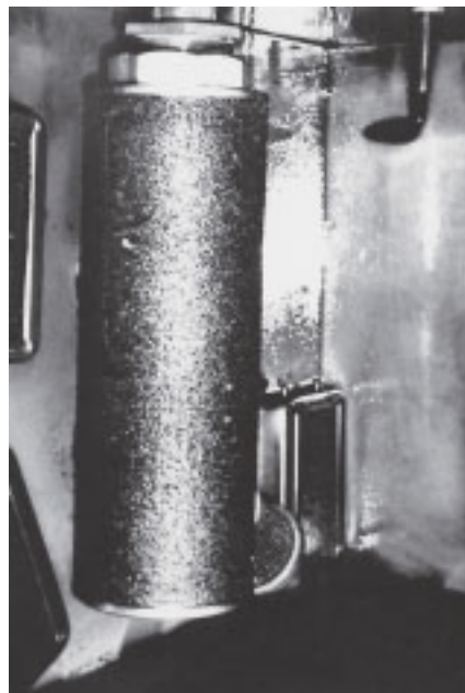
油圧タンク内部のサクシヨンストレーナー部に大量に付着している酸化変質物
