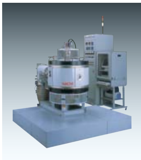
標準型イオンプレーティング装置 汎用の工具、金型部品など小物のコーティングに最適なイオンプレーティング装置です。縦型プラズマ電子銃による溶解方式で品質が優れ、コストパフォーマンスも良好です。 主なコーティング膜: TiN, TiCN, CrN
