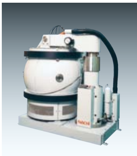
量産型イオンプレーティング装置 大型の金型や量産品のコーティングに最適なイオンプレーティング装置です。球型の真空室を持ち、取り扱い操作が容易。大型品の脱着も手軽に行なえます。 主なコーティング膜: TiN, TiCN, CrN
