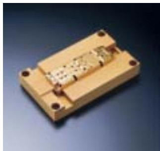
樹脂成形用金型 (TiN/CrNコーティング) 携帯電話金型など樹脂成形用金型の離型性、耐摩耗性を向上します。
