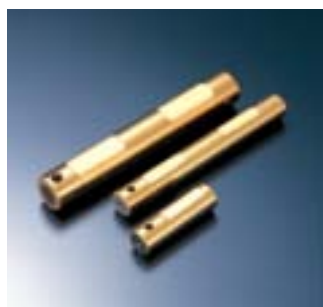
デフ・ピニオンシャフト (TiNコーティング) ギヤシャフトの耐久性を向上し、エンジンの高出力化に対応。
