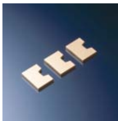
ロータリーコンプレッサー用ベーン (TiN/CrNコーティング) 代替フロンによる異常摩耗を防止。摩擦の低減、騒音防止にも貢献。
