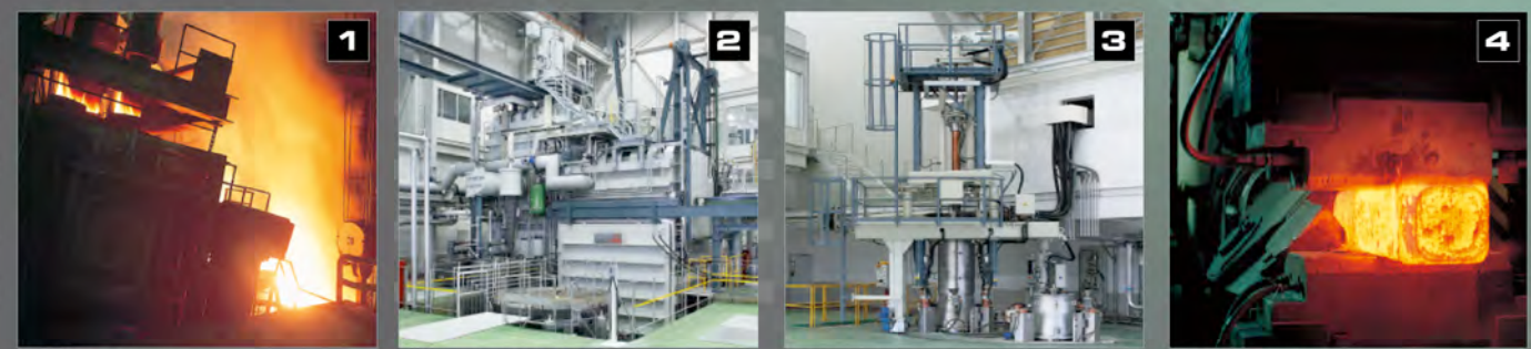
1 アーク炉 30ton 2 VIM炉(真空誘導溶解) 3ton 3 ESR炉(エレクトロスラグ再溶解) 3ton 4 鍛造プレス 1650ton
